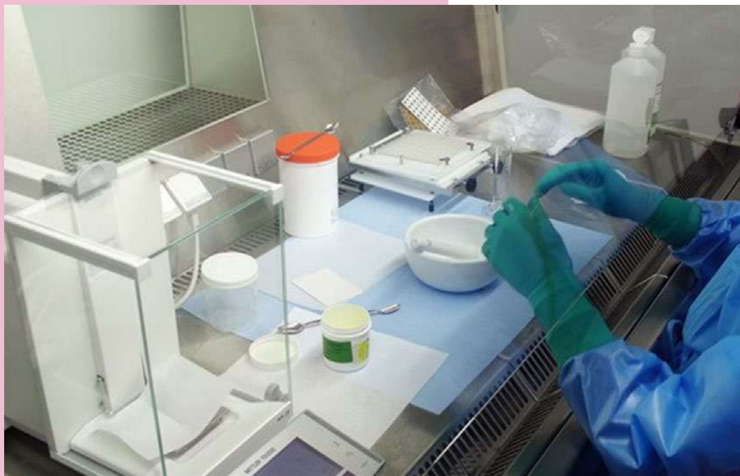
Imagen 10-6: Producción de cápsulas en una BSC en Pharma Assist BV (Países Bajos). La utilización de MP en polvo es una actividad de alto riesgo que puede generar partículas en suspensión en el aire
