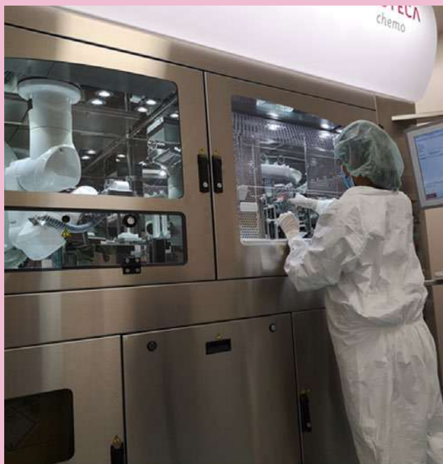
Imagen 10-3: Preparación de bolsas de infusión con MP en un sistema robótico automatizado en el Centro Médico de la Universidad de Ámsterdam (Países Bajos). Los operarios llevan el equipo de protección individual.
